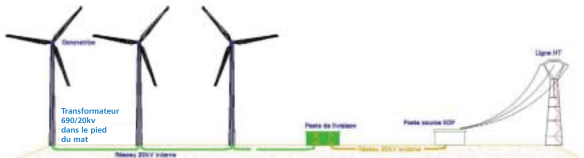
Figure : Représentation du raccordement d'un projet éolien
