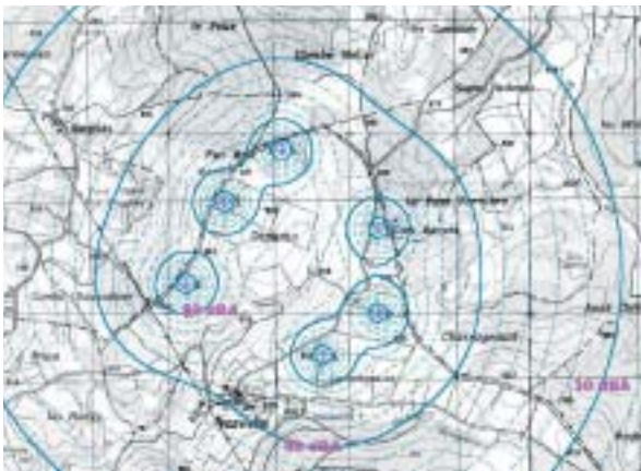
Figure 39 : Courbes isophones autour d'une centrale éolienne
