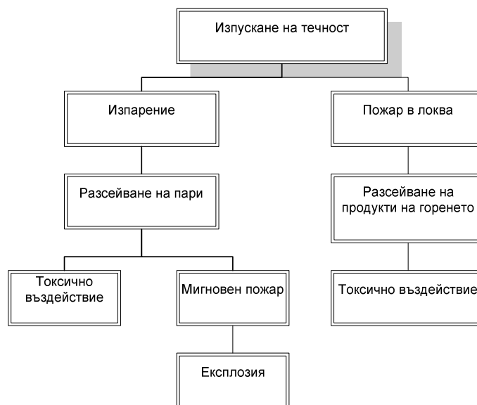
Фиг. 3. Дърво на събитията при изтичането на течност
