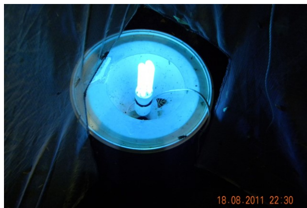
Светлинна ловилка с 8W луминесцентна тръбна лампа на 12V.
