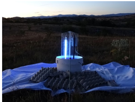
Светлинна ловилка с 8W луминесцентна тръбна лампа на 12V.
